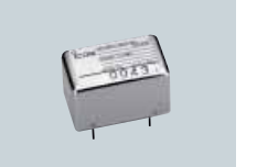
CR-338 CRISTAL HAUTE STABILITE Circuit de compensation de température pour avoir une meilleure stabilité en fréquence. Stabilité en fréquence : ±0,5 ppm
