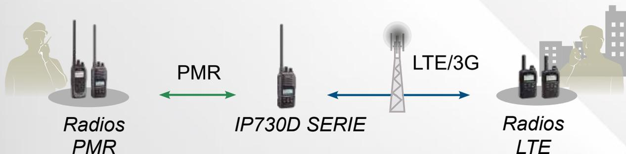
La fonction "répéteur / passerelle" assure également l'établissement d'une connexion entre deux réseaux PMR distants même en cas d'utilisation de fréquences ou de canaux différents.
