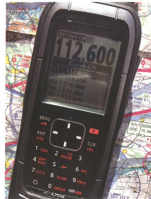
La fonction Recall permet de retrouver les 10 stations précédemment utilisées... très pratique!
