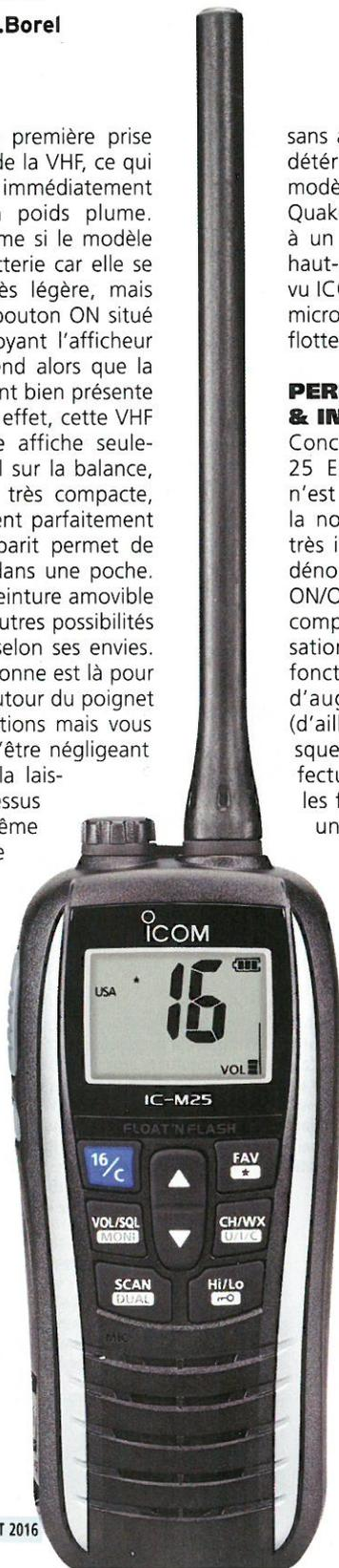
sans aucune crainte de perte ou de détérioration. Notez aussi que le modèle dispose de la fonction Aqua-Quake automatique qui s'apparente à un dispositif d'éjection d'eau du haut-parleur après immersion. Bien vu ICOM. Enfin, même avec l'option micro (HM-213), la VHF continue de flotter avec cet accessoire.
