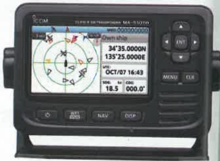
de ce transpondeur 2W, avec un écran couleur haute définition et non plus monochrome. Livré avec son antenne GPS, il permettra de surveiller de nombreuses cibles à l'aide d'alarmes visuelles et sonores automatiques et de déclencher un appel ASN via une VHF Icom connectée.
