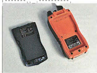
La batterie est de type amovible, mais il faudra sortir un tournevis pour serrer sa vis de blocage.
