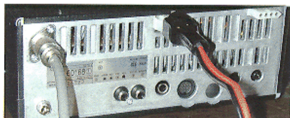
Notez à droite de cette vue la prise qui permet de commander la boîte de couplage externe.
